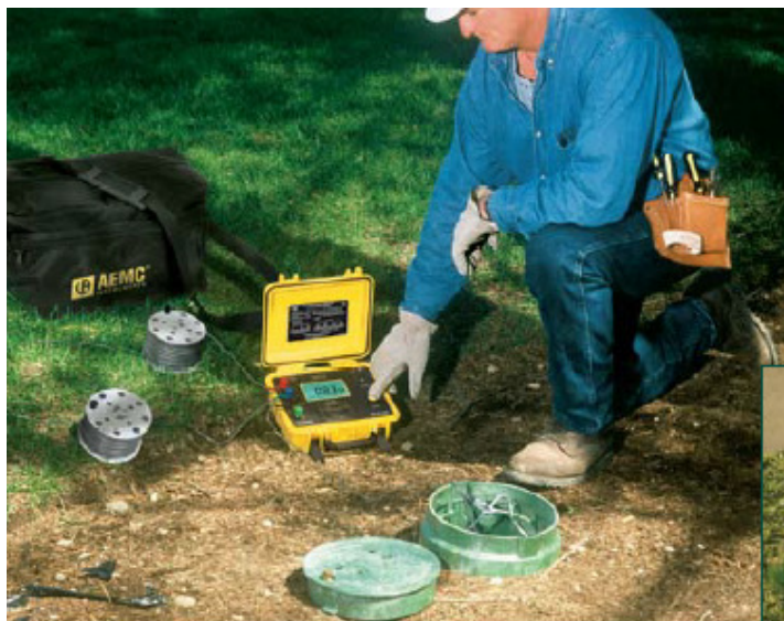
เครื่องวัดความต้านทานจำเพาะของดินและวัดความต้านทาน ของระบบสายดิน(AEMC, USA)
